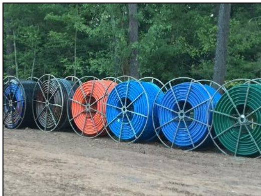
HDPE Conduit for fiber optic
